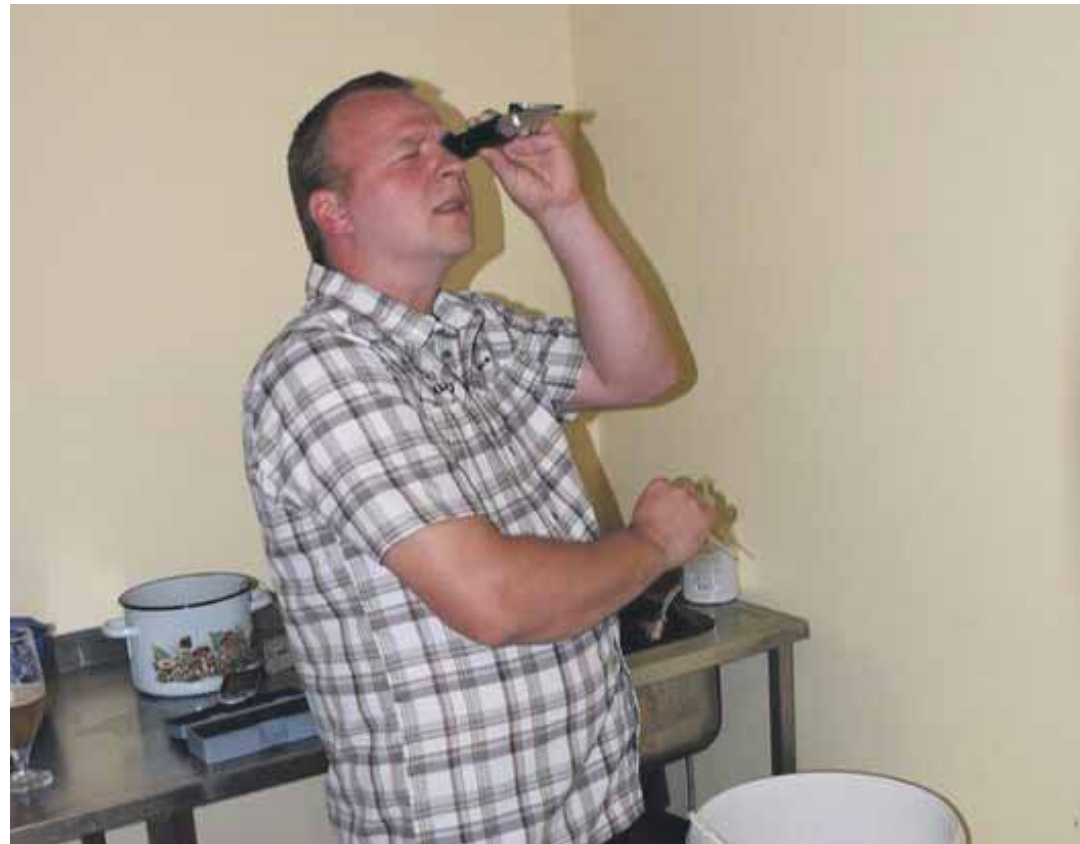
Raavo Vask mõõdab refraktomeetriga õlle algvirde tihedust.
